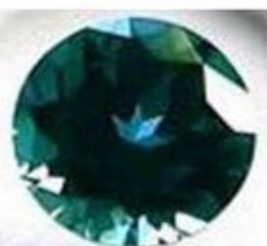
Рис. 50 Кристалл синтетического александрита, выращенный из расплава методом Чохральского. Продукция лаборатории №6 Конструкторско-технологического института монокристаллов, г.Новосибирск
